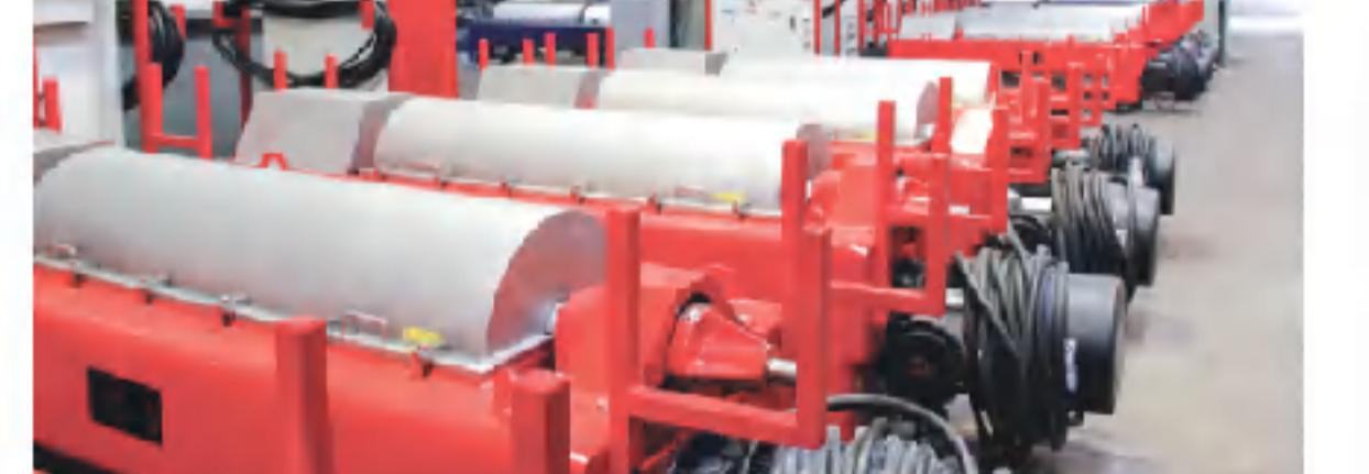
摆线齿轮、行星齿轮和液压差速器三种差速系统，差速调节范围大，工况适应性强。
